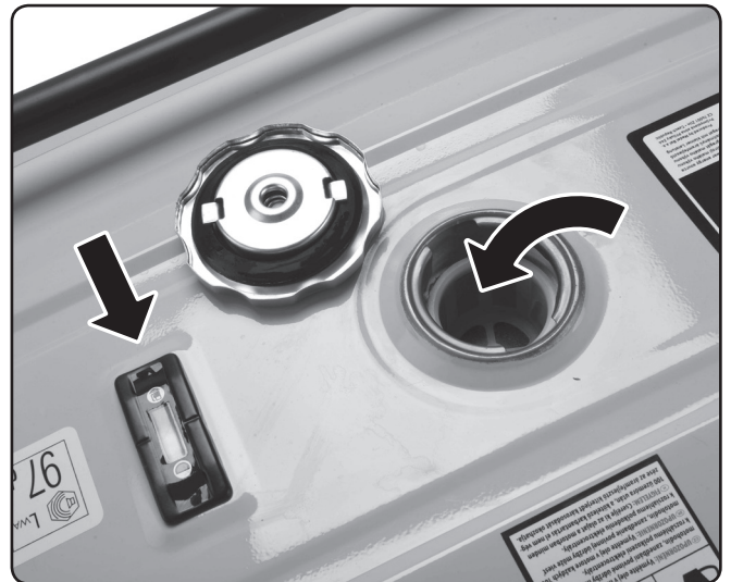
Рис. 13, вказівник рівня пального та сітчастий фільтр у горловині паливного баку
